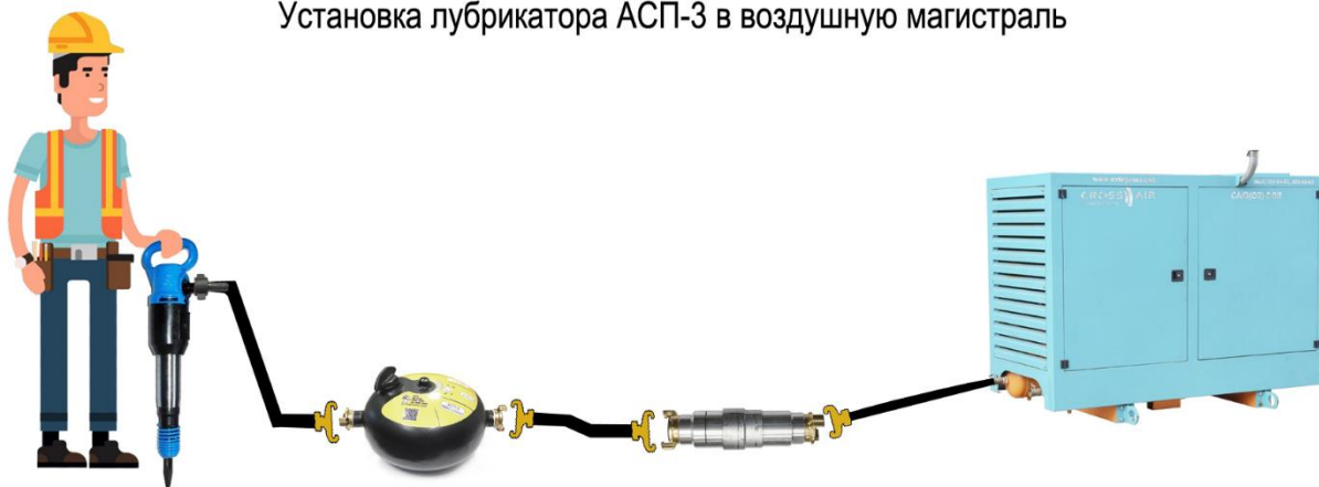
Установка лубрикатора АСП-3 в воздушную магистраль
